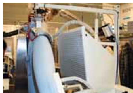
Der neue MaxiShirty mit integrierter Wärmerückgewinnung (unten).
